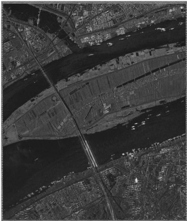
成像方式：聚束（1米HH极化）
